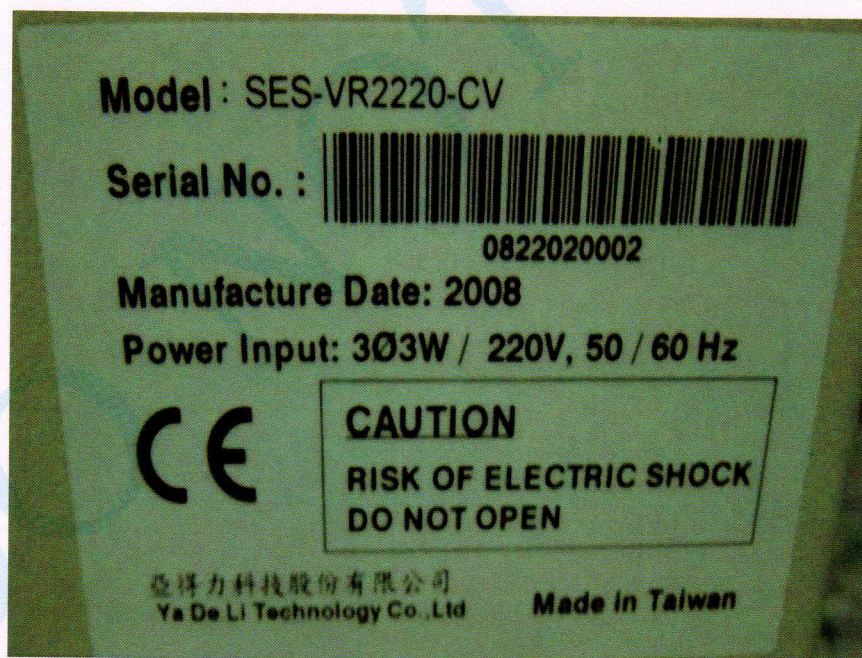
圖片 6 受測主機壓縮機使用之變頻控制系統銘牌-2
